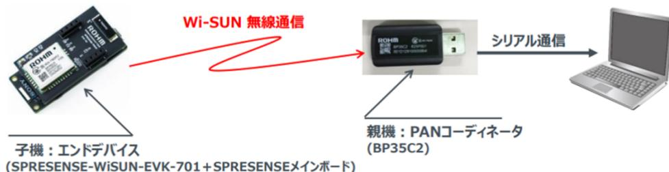
SPRESENSE-WiSUN-EVK-701を子機としてUSB dongle BP35C2に対して定期的に無線データの送信を行います。
